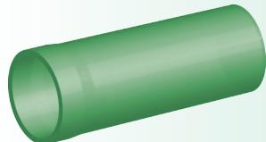
Раструбные трубы из стеклопластика применяются при прокладке напорной или безнапорной канализационной системы в подвижных грунтах. При изготовлении труб используется метод непрерывной намотки стеклянных нитей, пропитанных эпоксидным связующим веществом. Двойной резиновый уплотнитель обеспечивает герметичность стыков.
