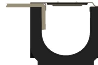
Уникальная конструкция ливневой решетки Sport позволяет заводить дренажный мат спортивного поля в водоотводной лоток, что позволяет более эффективно собирать и отводить излишки влаги.
