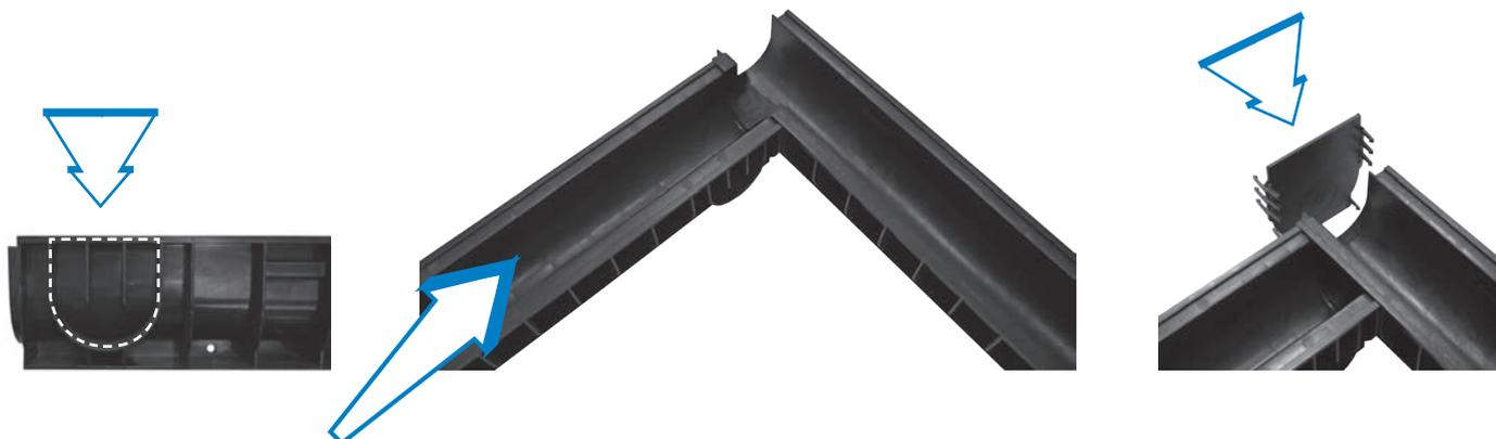
1. Вырезать отверстие в боковой стенке лотка (специально обозначенный стыковочный узел).
