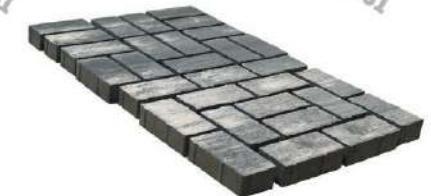
Цветная тротуарная плитка такой формы толщиной от 50 мм изготавливается только по технологии двойного вибропрессования и обладает прочностью более М350.
